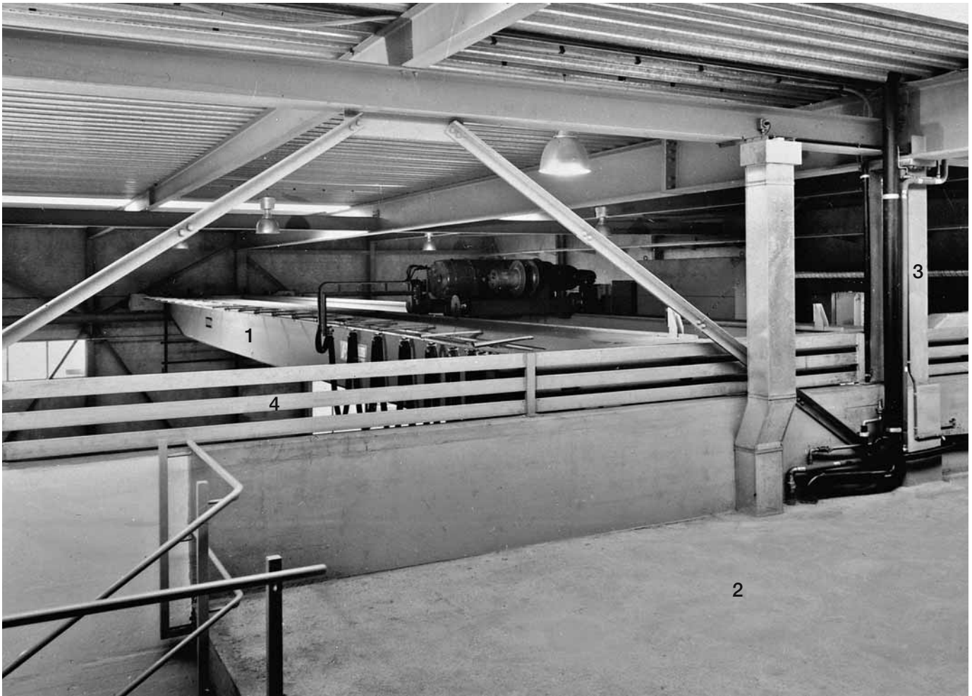
Bild 9: Zweiträgerkran in einer Fabrikationshalle. Die Fahrbahn des Krans ist vom zugänglichen Dach eines Büros aus erreichbar. Zur Sicherung der Klemmstellen zwischen Gebäudestützen und Kran ist im Zugangsbereich eine glatte, durchgehende Wand eingezogen.
